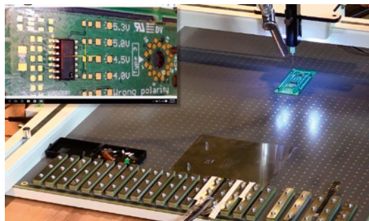
eC-placer w trybie pobierania i układania
