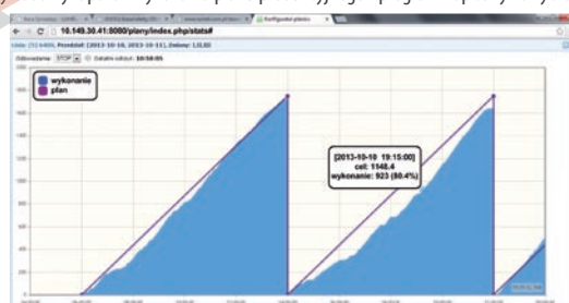
monitoring i sterowanie procesem produkcyjnym za pomocą programu LUMEL-PROCES
