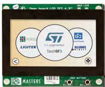
Rys. 2. Płyta demonstracyjna MASTERS dla wyświetlaczy LCD TFT 4,3-cala (EVB.DIS.D002.TFT4.3).
