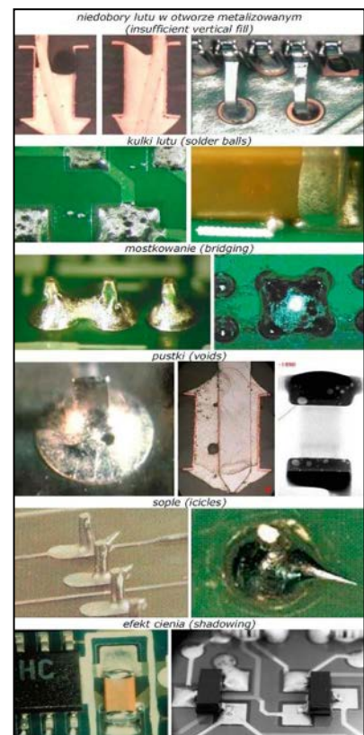
Fot. 2. Typowe wady montażowe
