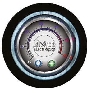
DMG48480C028_03WTC , Okrągły wyświetlacz o przekątnej 2,8" i rozdzielczości 480x480 z pojemnościowym panelem dotykowym i białym lub czarnym szkłem ochronnym.
