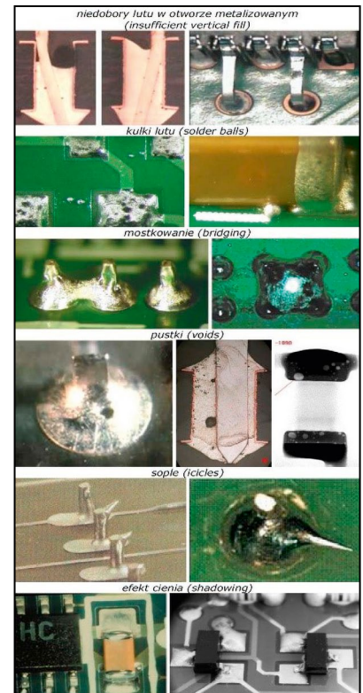
Fot. 2. Typowe wady montażowe
