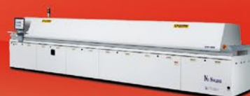
Piec lutowniczy z serii N30i z wbudowanym generatorem azotu
